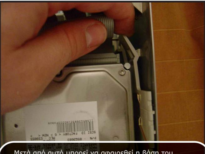
Μετά από αυτό μπορεί να αφαιρεθεί η βάση του σκληρού δίσκου και του φλοπού. Και αυτό γίνεται με παρόμοιο τρόπο, με την απελευθέρωση ενός άλλου γάτζου: Και μετά η αφαίρεση γίνεται συρταρωτά με κατεύθυνση προς το τροφοδοτικό.
